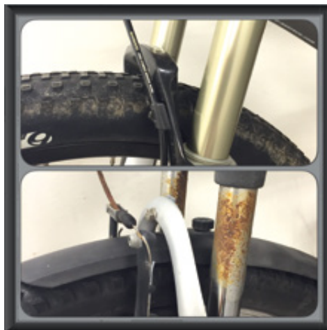
Typisk dyr og billig forgaffel. Den billige er tung og rustet let.
